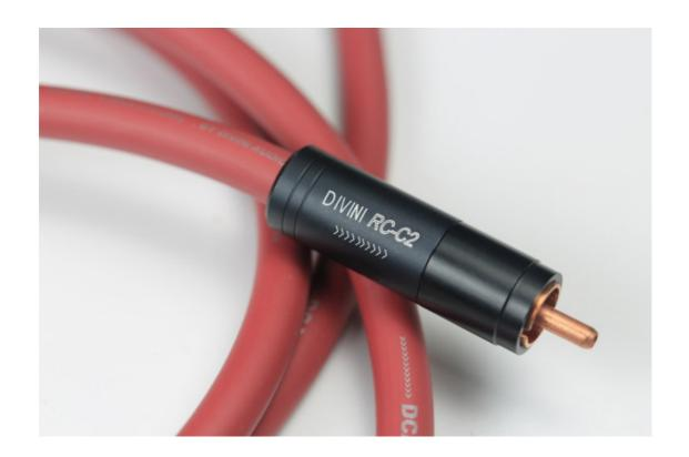
Divini 全新的 DCA-2 同軸數位線,線身材質柔軟,在使用上的彈性更大,讓線材、器材與空間的配合度更加提升。DCA-2 雖然沒有華麗亮眼的外型,但用料相當的紮實,導體採用 PC-OFC 結晶無氧銅鍍銀處理,導體結構是以 19 芯 0.2mm直徑,三層絞合而成。Divini 強調 DCA-2 導體是採外鍍 20u 厚銀處理,這樣的設計除了因為銀具有較佳的高頻傳導能力外,一般鍍薄銀的導體會有高頻較為刺耳的感受,而鍍厚銀則是可以讓 DCA-2 沒有這樣的困擾。
